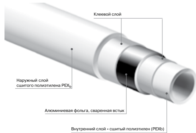
Рисунок 1. Структура трубы PE-Xb/Al/PE-Xb
